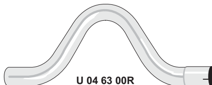
U 04 63 00R Bakaxelrör med muff, ca 900 mm Over-axle bend, 900 mm
